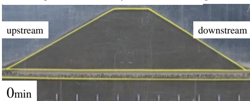
図-8 堤防底部に砂礫層を有する場合の浸透破壊実験：(a)上図，砂層部：豊浦砂；(b)下図，砂層部：上層珪砂7号・下層珪砂2号。右の写真は堤内側法尻部における実験から45分後の様子。
