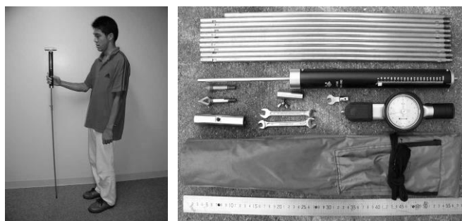
図2 土層強度検査棒2)
