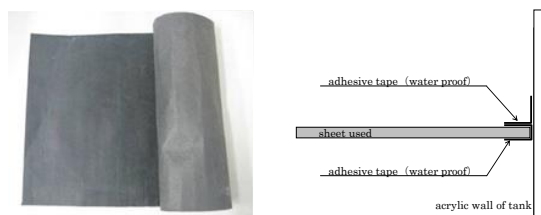
図-2 左: 透気遮水シート, 右: シートと土槽の結合方法
