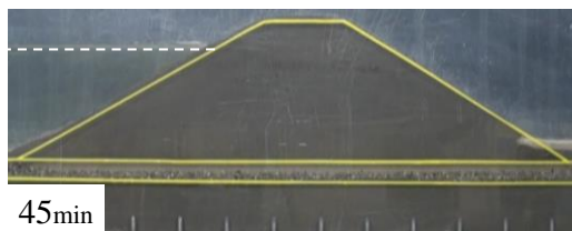
図-8 堤防底部に砂礫層を有する場合の浸透破壊実験：(a)上図，砂層部：豊浦砂；(b)下図，砂層部：上層珪砂7号・下層珪砂2号。右の写真は堤内側法尻部における実験から45分後の様子。
