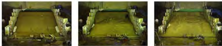
Case1 のり面勾配 1:2 Case2-1 のり面勾配 1:1.5 Case2-2 のり面勾配 1:1.5(降雨有り)
