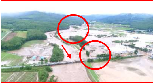
空知川の堤防決壊状況 (南富良野町)
