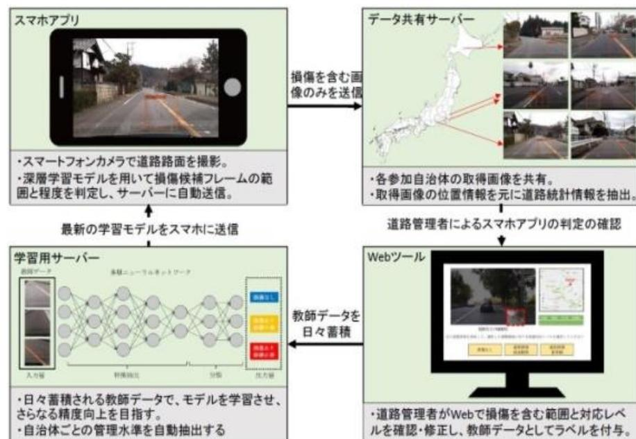
I O T ・ 機械学習を用いた道路舗装損傷や管理水準等の自動抽出イメージ (東京大学)
