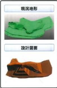
3次元測量データ(現況地形)と設計図面との差分から、施工量(切り土、盛り土)を自動算出。
