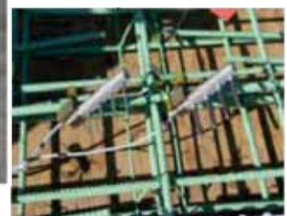
コンクリート湿度・腐食センサー
