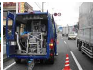
FWD調査 (舗装全体)
