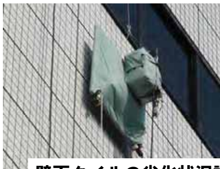
壁面タイルの劣化状況調査ロボット
