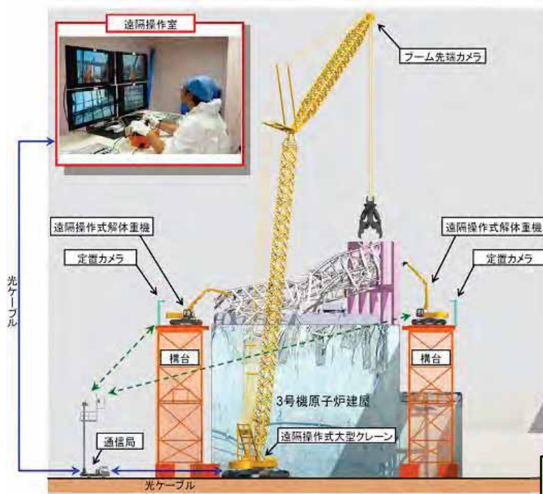
3号機におけるガレキの撤去
