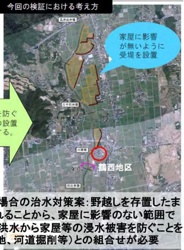
国土交通省:野越しを存置する場合の治水対策案:野越しを存置したままでは家屋への浸水が想定されることから、家屋に影響のない範囲で堤防(受堤)を設置し、越水した洪水から家屋等の浸水被害を防ぐことを前提とするが、他の方策(遊水地、河道掘削等)との組合せが必要
