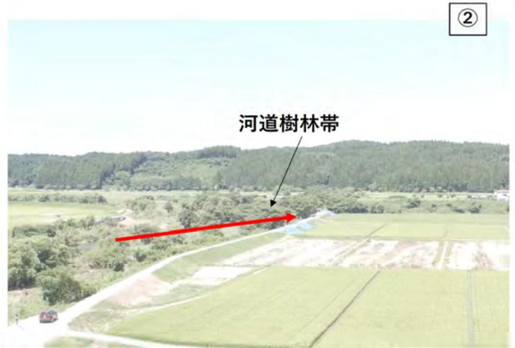
河積の小さい中小河川 + 「平坦」, 「屈曲」, 「樹林化」 + 本川合流部付近により、越流発生しやすい条件が重複する。
