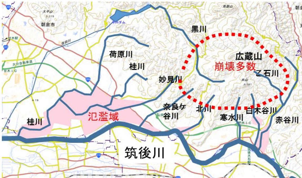
図 4.7.1 平成 29 年九州北部豪雨における朝倉市の被災河川（土木学会調査団速報より）
