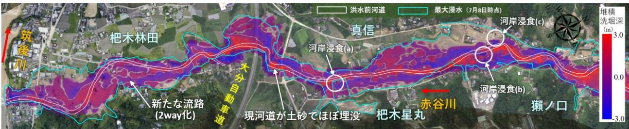
図 3.7.11 氾濫シミュレーションによる河床変動高コンター (洪水終了時)
