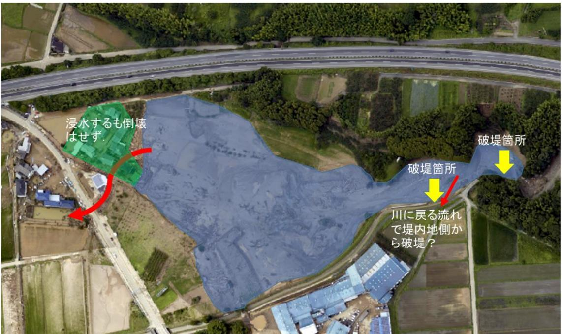
図 3.2.5 災害時の破堤地点周辺の状態
