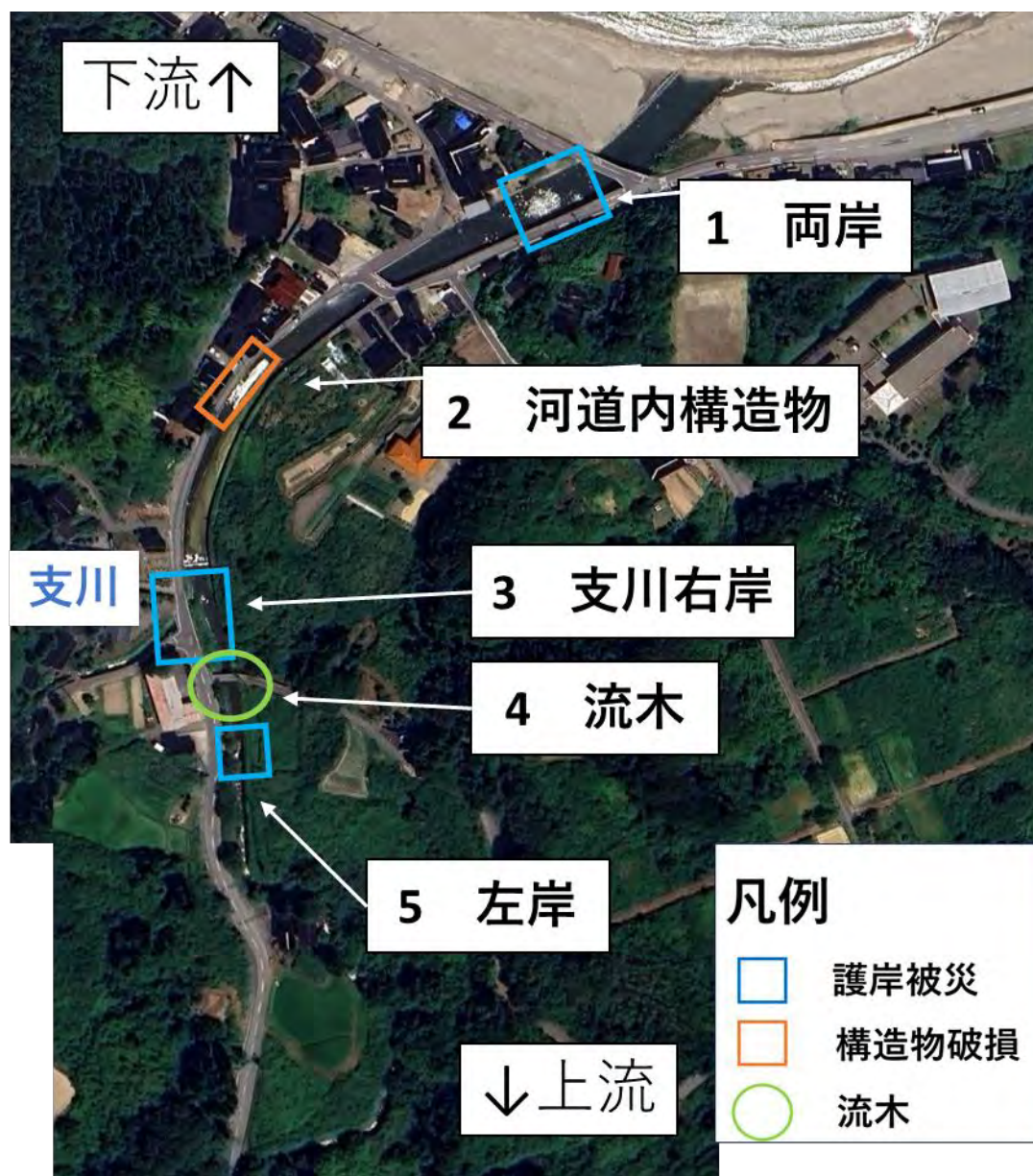
図 10-21 折戸川における河道内被災状況の調査地点・範囲（緑○の範囲に流木が堆積しており、青□の箇所で護岸被災、オレンジ□の箇所で河道内構造物破損が見られた）
