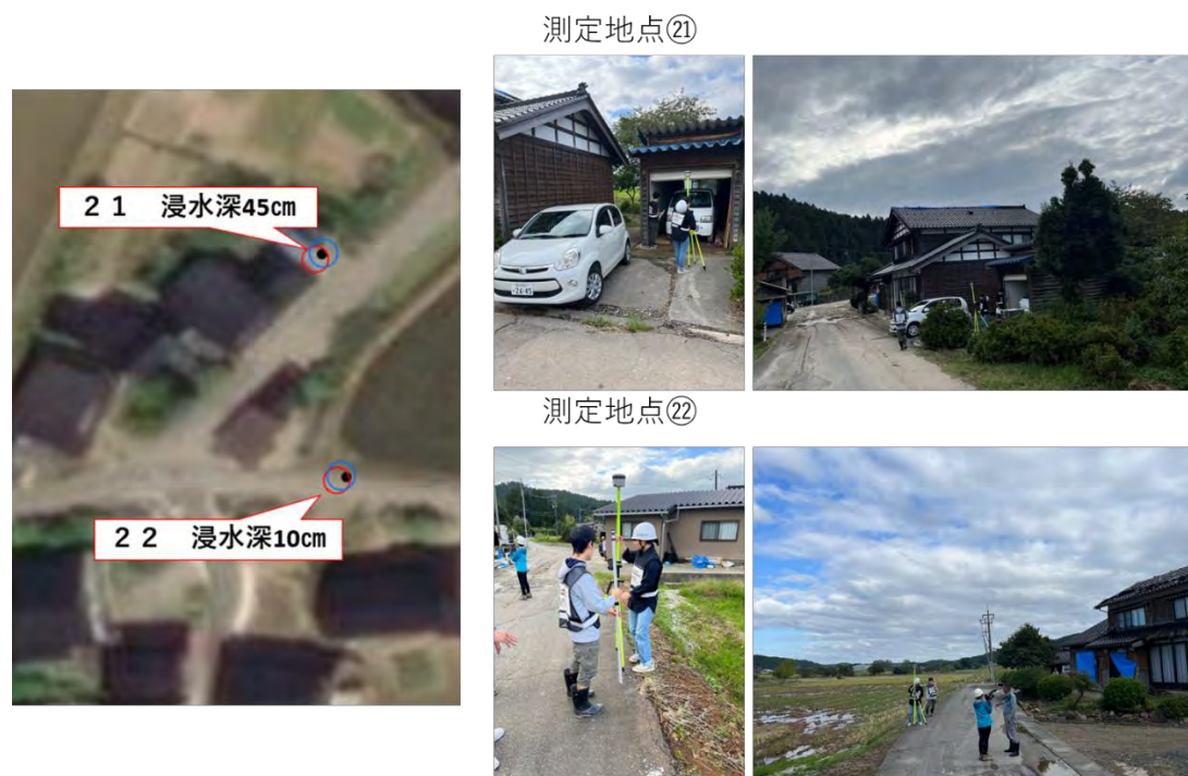
図 10-9 若山川における調査地点の様子と浸水深の分布（測定地点 21～22）
