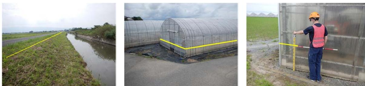
写真7.1 痕跡水位（左：図7.5中①，中：図7.5中②，右：図7.5中③）
