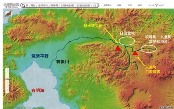
図3.6 筑後川流域(盆地地形と pair の流出狭窄部で被災)
