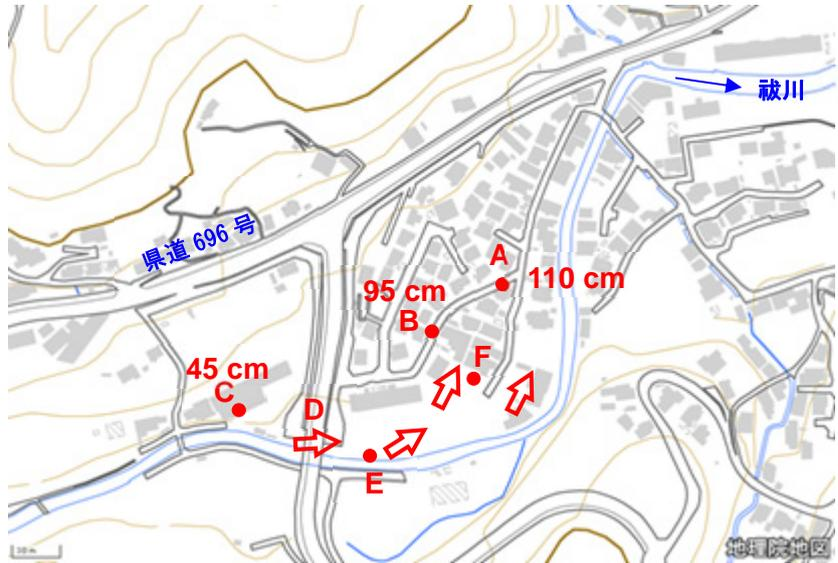
図5.4 下八幡地区の浸水痕跡調査結果
