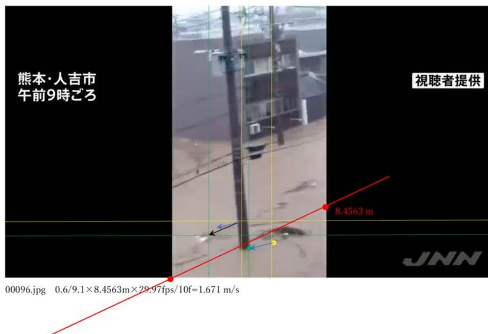
図 2.14 球磨川・人吉市における氾濫流速の算定結果の一例
