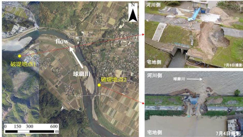
図 5.14 破堤地点および破堤状況 (国土交通省九州地方整備局, 2020)
