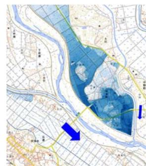
図10.4 合流部の浸水例
