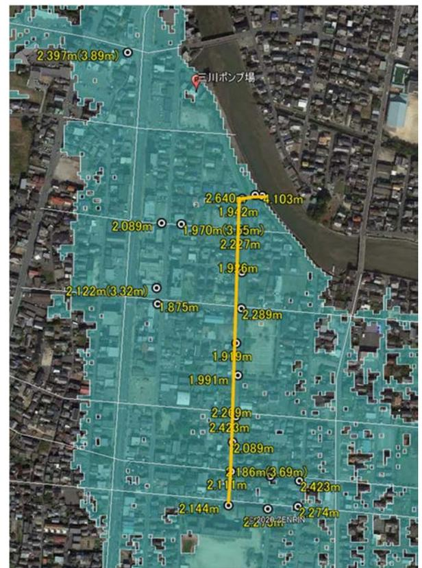
図4.7 地盤高測量ライン
