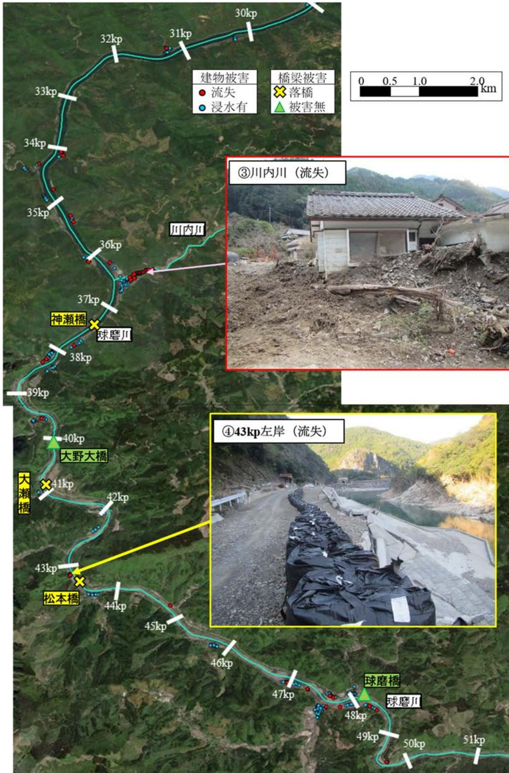
図 8.6 建物被害・橋梁被害マップ (29～51kp)
