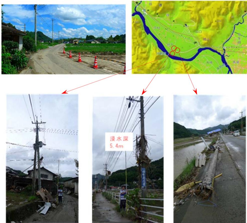
図 1.7 沖鶴橋付近の蛇行部に沿った堤内地の被害状況
