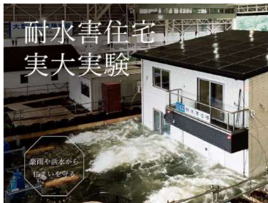
耐水害住宅の実大実験 (一条工務店)
