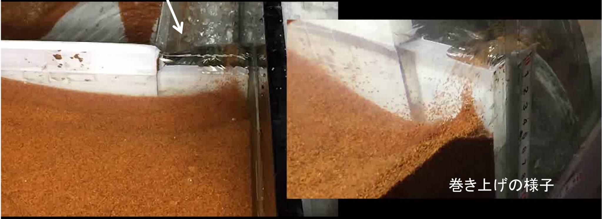
堰の開口部周辺では土砂が巻き上げられ、洗掘が発生する。
