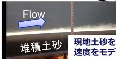
現地土砂を用いた実験で侵食速度をモデル化(中部電力)
