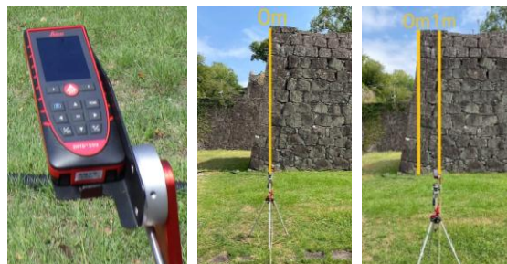
図-1 レーザー距離計（左）と設置状況
