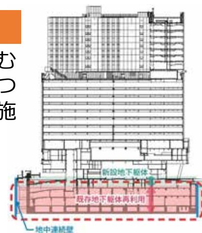
既存建築物の活用の例
