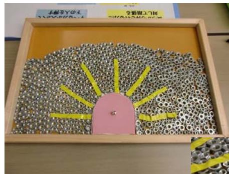
写真-2 土粒子はナットで表現。アンカーボルトがグラウト（充填剤）を介して地盤と一体化している様子をナットにくっつけたビニールテープで表現している。
