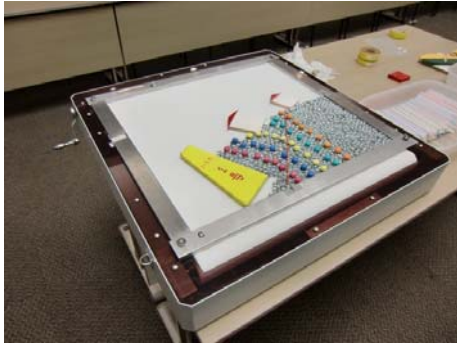
写真-3 擁壁が土の崩れを防ぐことを説明する模型。写真左奥のハンドルをくるくると回すとスクリーン（白い部分）がスライドして、ナットが模した地盤が崩れる。（黄色い擁壁は、「まもるくん1号」。さらに大きい擁壁「まもるくん2号」もあり、こちらでは土が崩れるのを防ぐことができるようになっている）
