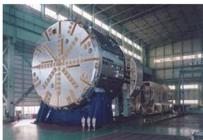
写真-1 直径約 13m の TBM (tunnel boring machines) (写真：NEXCO 中日本)
