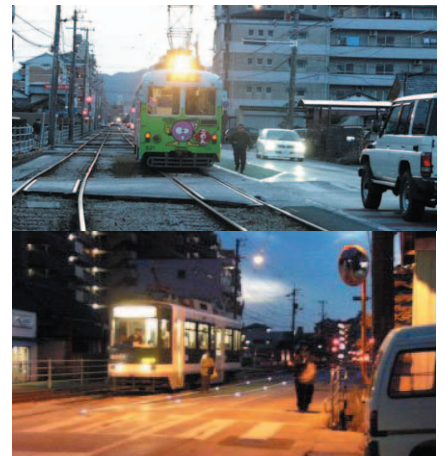
写真-3 ノーガード電停(緑色の部分。夜は路面電車接近時ライトアップによる安全対策)
