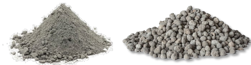
図 6.2 左：炭酸塩化後の粉体、右：炭酸塩化・造粒後の骨材
