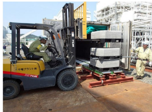
図 1.2 養生槽への CO 2 -SUICOM 製品搬入状況
