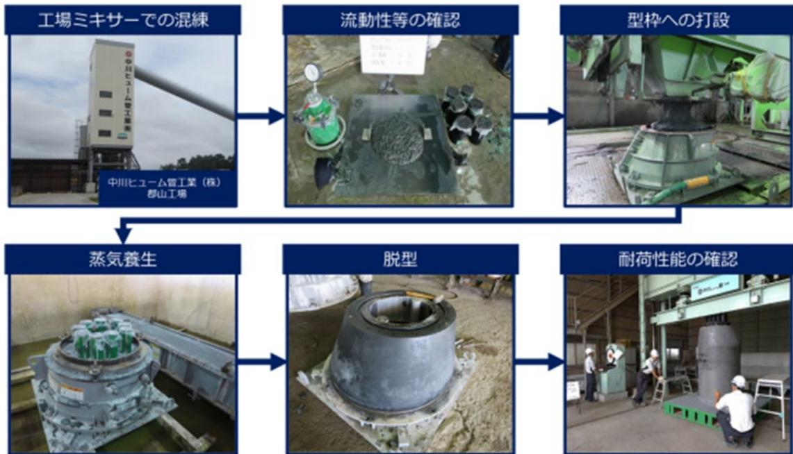
図 3.3.1-6 工場における EeTAFCON 製プレキャスト製品の製造風景<sup>6)</sup>
