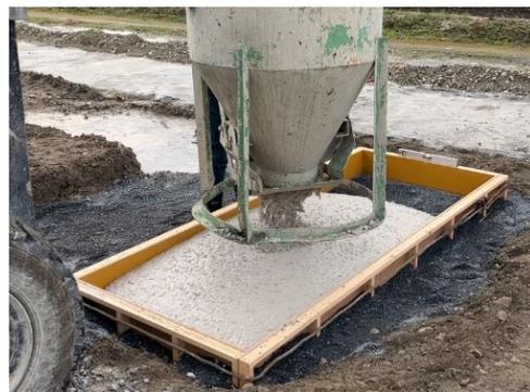
写真 20.2 土間での流動充填性
