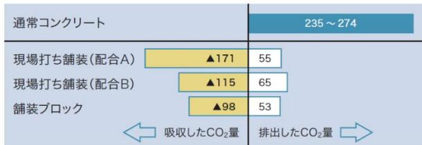
コンクリート製造時のCO<sub>2</sub>排出量の収支 単位(kg/m<sup>3</sup>)
