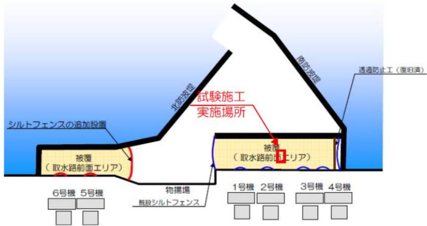
図 2-23 海底土の被覆施工箇所 16)より引用
