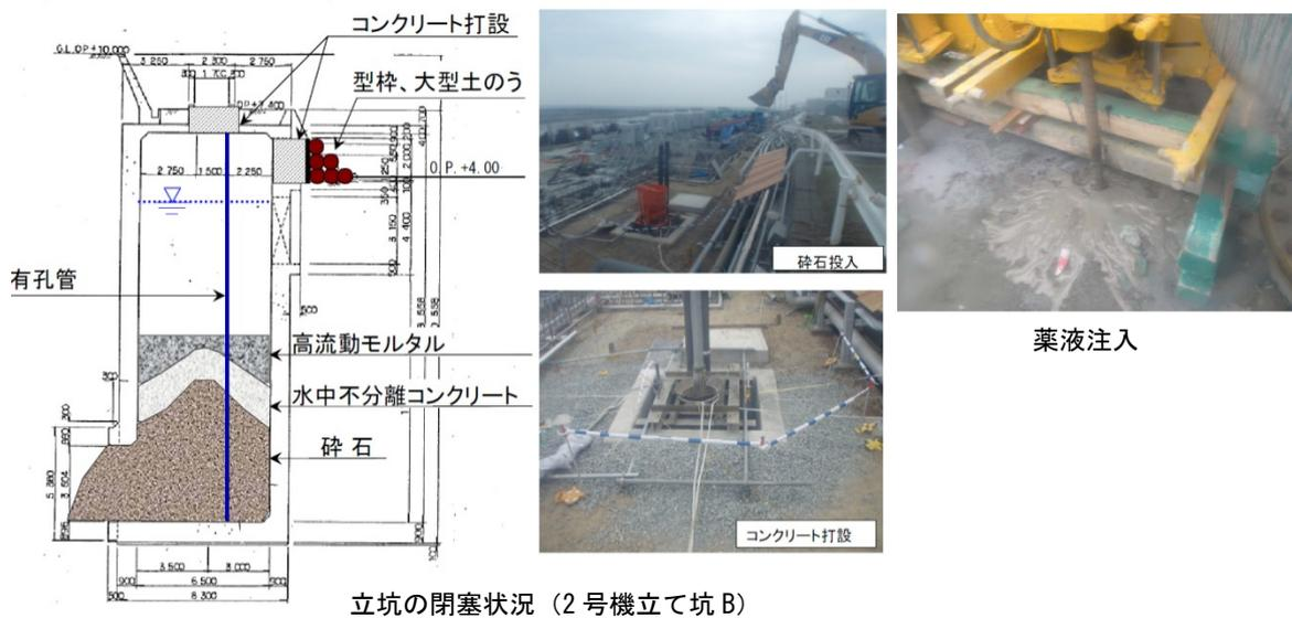
図 2-14 立坑・トレンチ・ピットの閉塞状況 <sup>12)</sup>より引用
