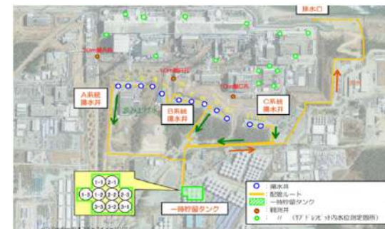
図3-43 地下水バイパス設備全体平面図
