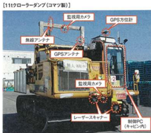
図 3-162 クローラードンプ自動走行システム
