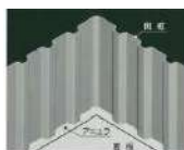
鋼構造止水壁（SUS鋼板等）
