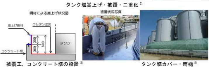
図 3-114 タンクヤード整備の概要
