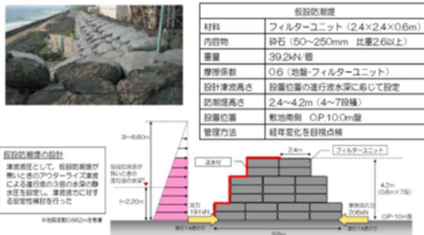
図 2-32 設計の考え方と仮設防潮堤の形状
