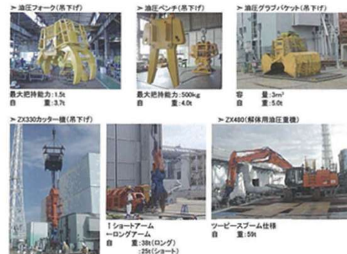
図 3-165 解体アタッチメント・解体重機
