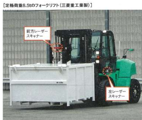
図 3-163 フォーク リフト自動走行システム
