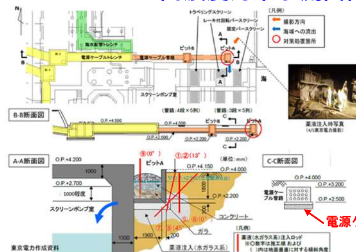
図 2-9 2号機取水口スクリーン室付近の流出防止対策
