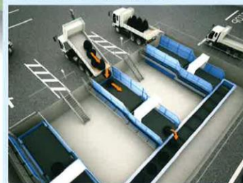
ダンプアップによる荷下ろし
