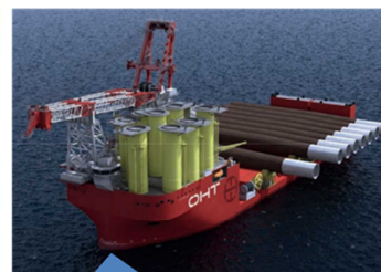
大型基礎設置船の例
