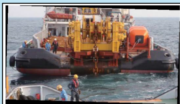
係留チェーン敷設
