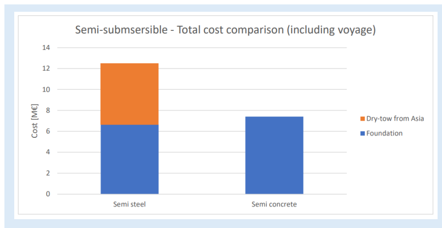
図-3.4.8 コンクリート製と鋼製のセミサブ浮体式基礎の製造コスト比較
