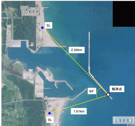
図 4.1 DSLによる洋上風況観測点の例(むつ小川原港)
