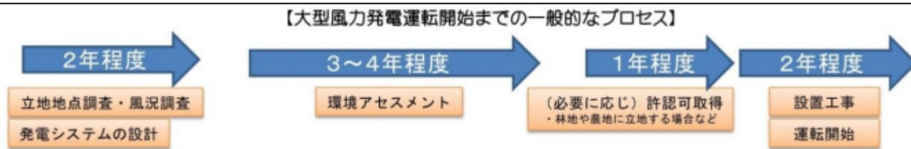
図 1-1 風力発電事業の一般的な事業工程 1
