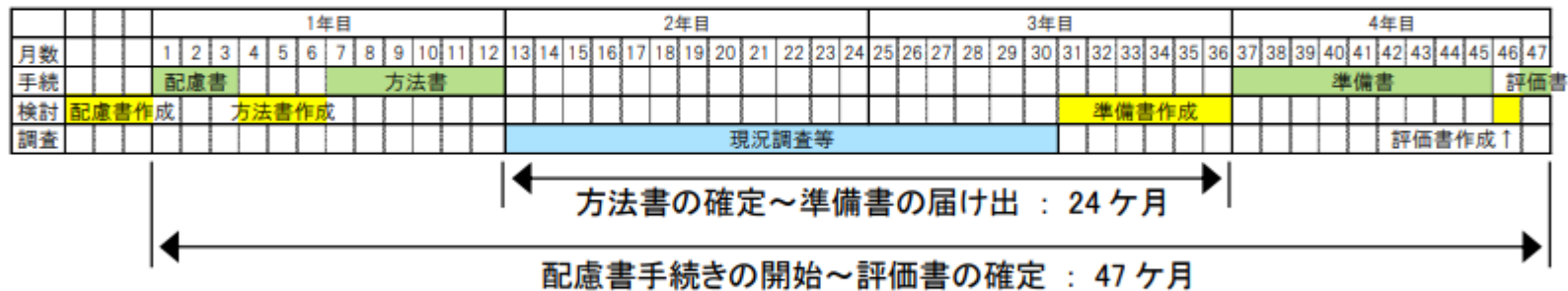
図 1-1 風力発電事業の一般的な事業工程 1
