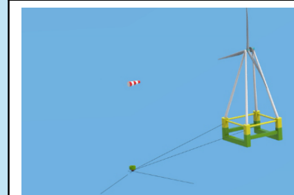
1点係留方式 (⑪Eolink)
