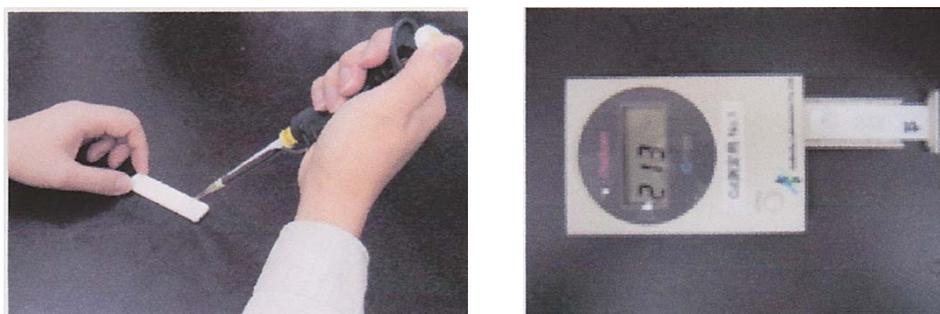
図 3.3.1-1 バイオセンサーによるカドミウムの測定<sup>1)</sup>
