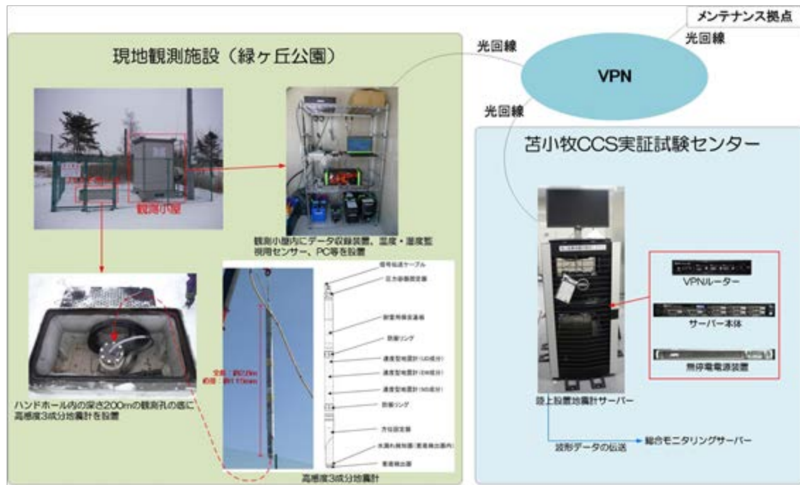
図 6.1-11 苫小牧実証試験サイトに設置されている地震観測システム (日本 CCS 調査提供)
