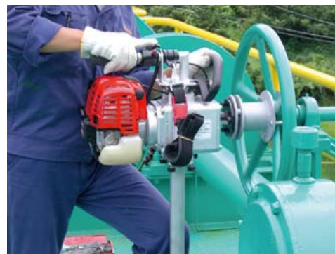
図 3.1.2.3-4 可搬式ゲート開閉装置.
