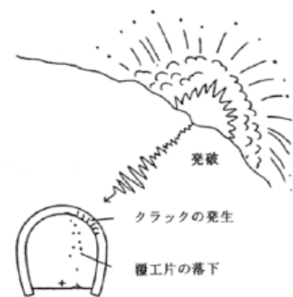
(i) 地盤振動 発破等の振動による地盤の挙動により覆工に変状が発生する。
