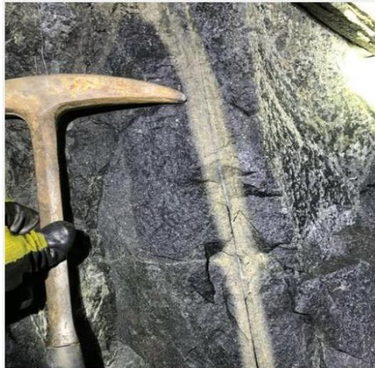
亀裂全面に生じた変質ハロー
