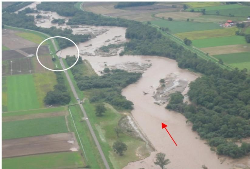
写真-1-1 堤防一部流出箇所全景
