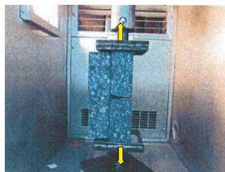
クラック防止シート効果確認試験（左側がオーバーレイ、右側が亀裂部を模擬） → 降伏時変位は約7mm（シート無しの場合は降伏時変位は約0.8mm）
