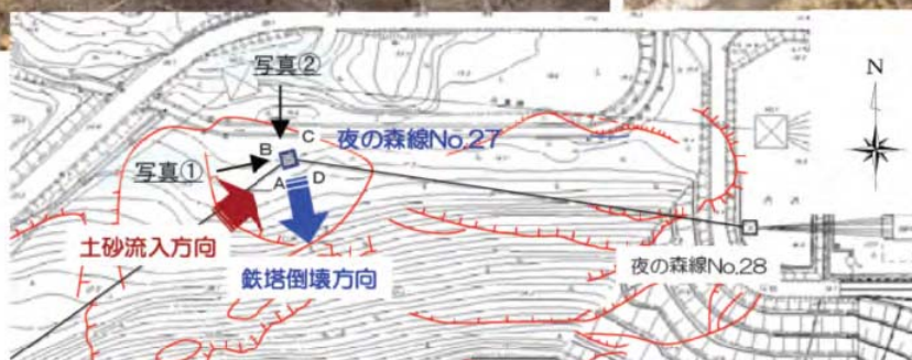
鉄塔の倒壊状況
