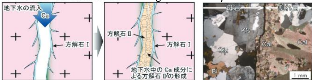
(c) 方解石 II による割れ目の充填 Sealing of fracture by calcite II
