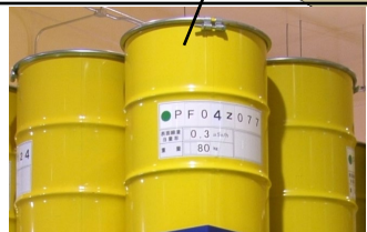
ドラム缶に廃棄物を収納し 固型化した廃棄体
