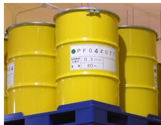
ドラム缶に廃棄物を収納し砂等を充填 200 liter drums
