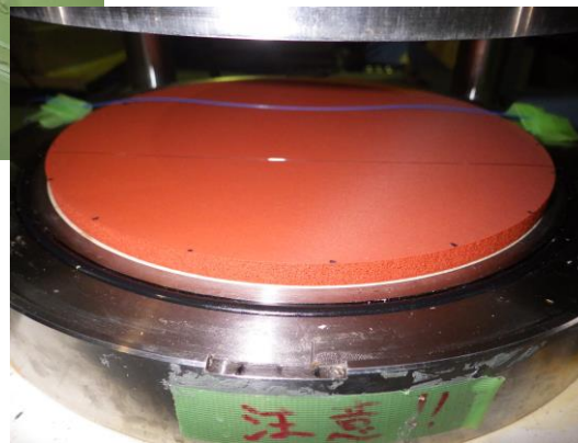
軟質ゴム上への光ファイバセンサ配置
