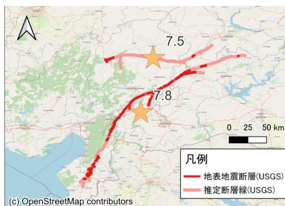
図-1 2023年2月6日発生 of Pazarcik 地震 (M7.8) と Elbistan 地震 (M7.5) の震央と地表地震断層, 推定断層線
