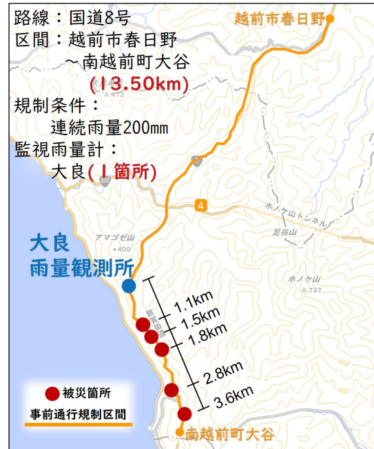
図-2 国道8号の被災箇所と事前通行規制区間
