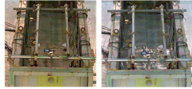
(a)起震前 (b)起震終了時 土槽の状況
