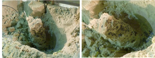
実験終了後の碎石柱の状況(写真はCase1実験時のもの)
