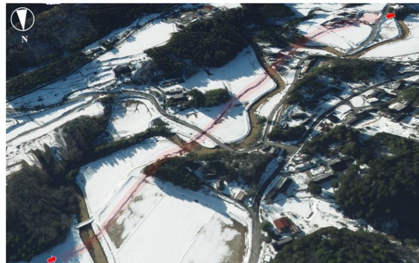
図3 3Dモデルでみた若山町中地区における線状の地表変状（赤線）
