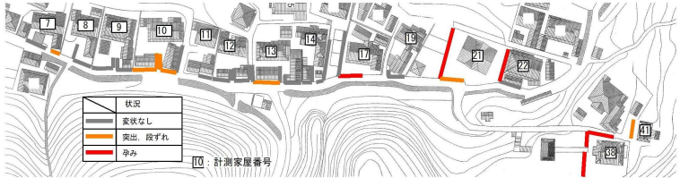
図-1 石垣の変状状況
