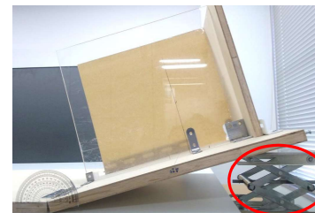
実験台 小型ジャッキ 毎秒1度の傾斜角を発生させる
