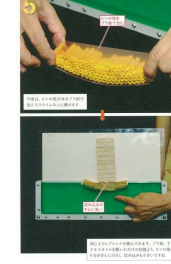
マットレス工法の模型実験
