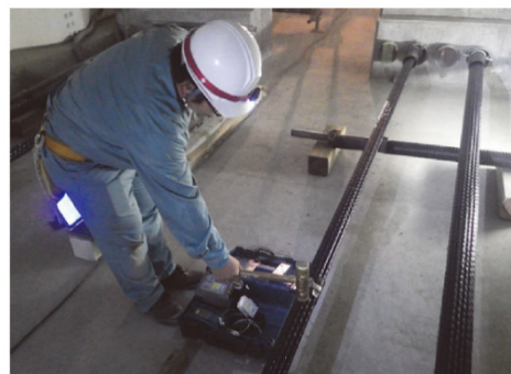
図-4.1.13.1 高次振動法による張力測定
