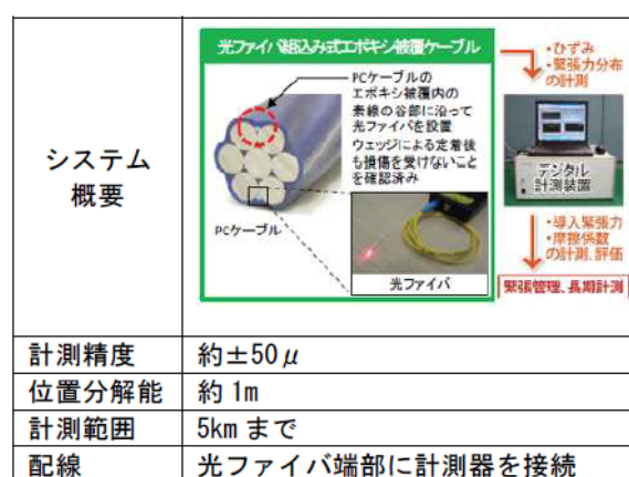
図-4. 1. 11. 1 BOTDR 方式によるひずみ計測の仕様
