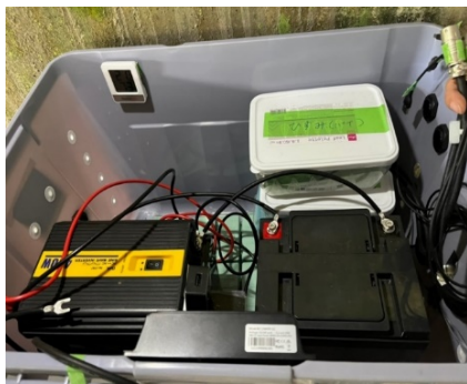
写真-4.4.5 IoT センサの収納ケース
