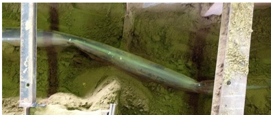
図 1-5-7 鋼管の変形（地中実験）
