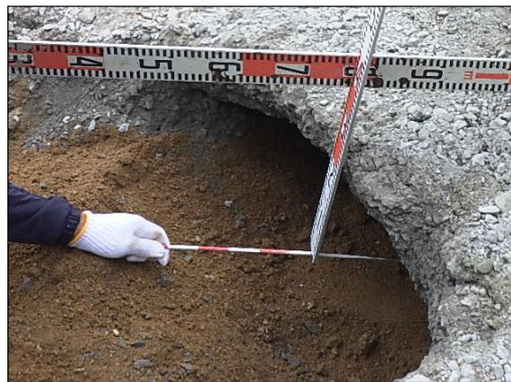
写真-3 空洞発生確認状況
