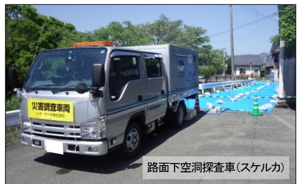
写真-2 熊本地震直後の路面下空洞調査状況
