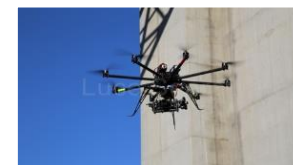
点検ロボット
