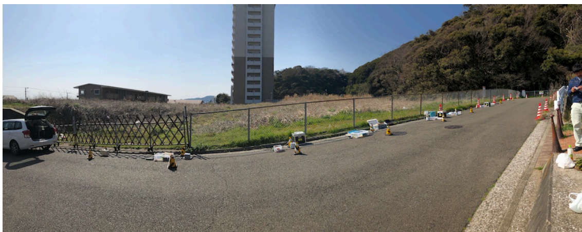
図 8.5-1 三浦断層帯直上における常時微動観測
