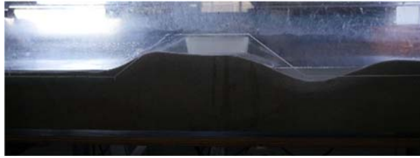
図-2.2.4 水路奥側から見た津波作用後の背面盛土の様子（舗装モデルなし；左側が沖）
