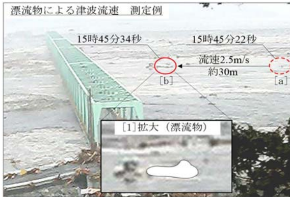
図-2.2.11 漂流物による津波流速の測定例
