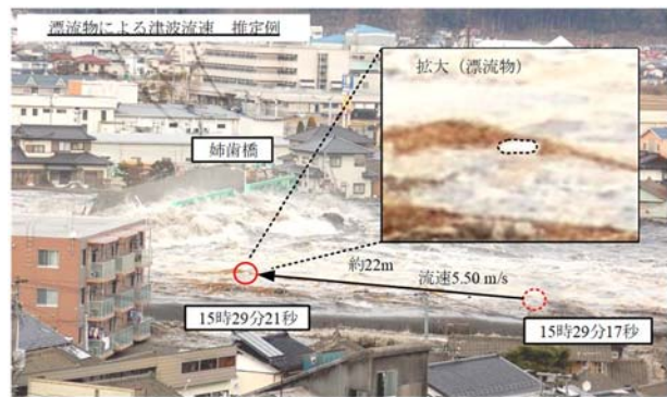
図-2.2.31 漂流物による津波流速の推定例 ([A]より撮影)
