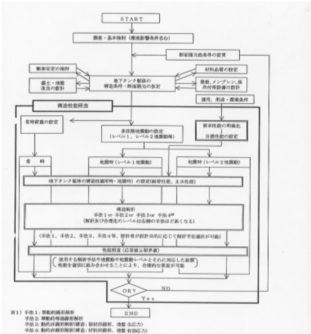
解説図 9.7.2-1 地下タンク躯体の性能照査のフロー<sup>1)</sup>
