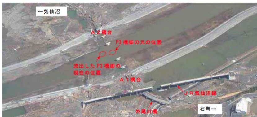
写真-3.4.23.2 小泉大橋及び外尾川橋周辺の航空写真 (国土交通省東北地方整備局提供、2011年3月19日(地震発生から8日後)撮影)
