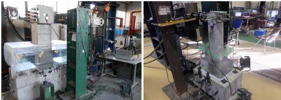
基部に水槽設置、1.5dの高さまで浸水
